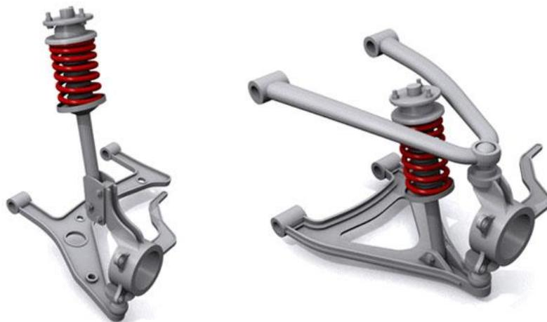
**Figura 2-7** - Suspensão MacPherson e Duplo A, respectivamente
