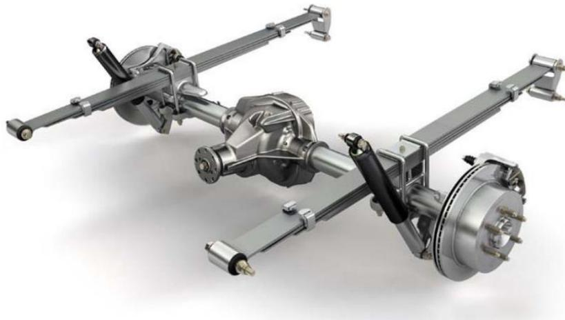
**Figura 2-3** - Suspensão de eixo rígido com feixe de molas
