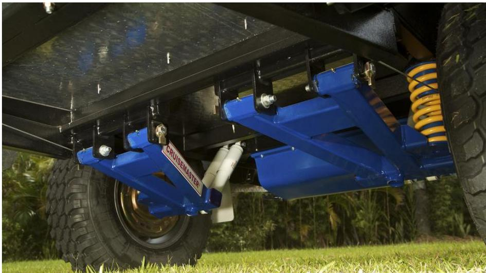
**Figura 2-5** - Suspensão *trailing-arm*
