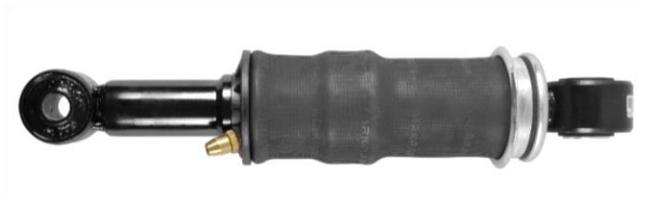
**Figura 2-21** - Exemplo de mola pneumática
