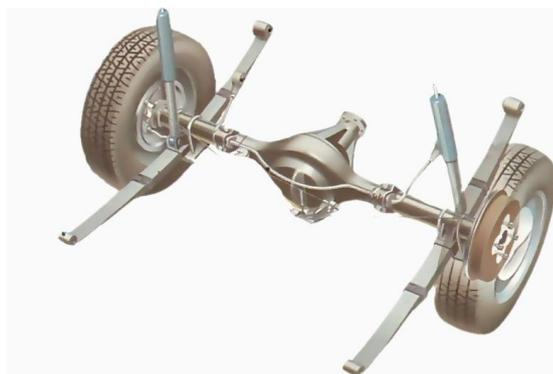
**Figura 2-17 -** Suspensão de eixo rígido
