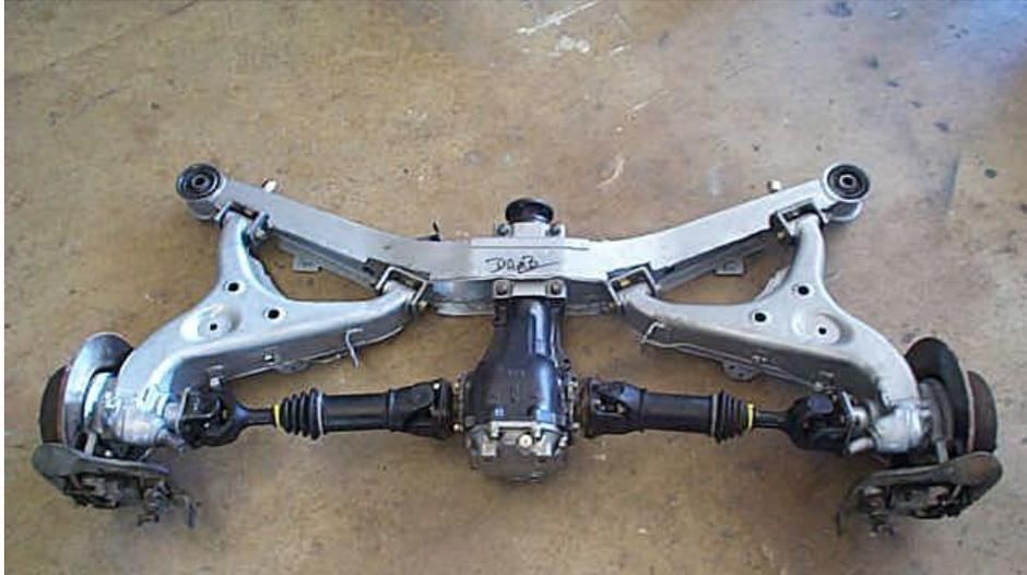
**Figura 2-6** - Suspensão semi-trailing
