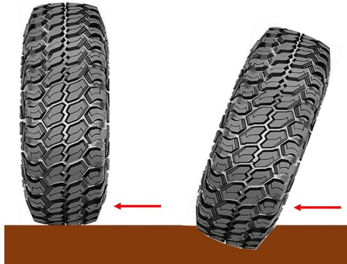
**Figura 5-2:** Esquema representando o comportamento do pneu em terra
