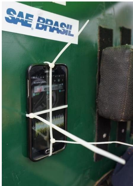
**Figura 4-12** - Fixação do celular no protótipo
